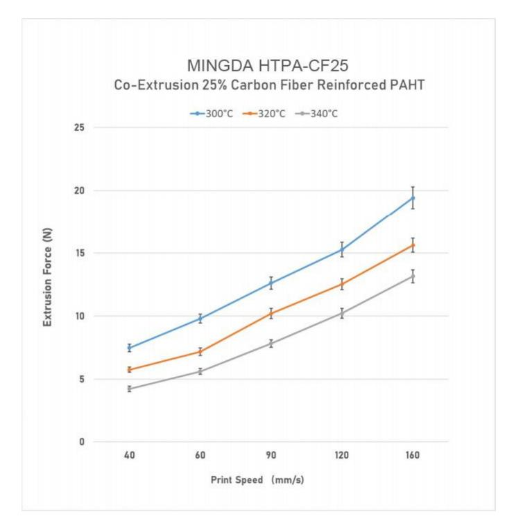
测试参数: 12mm 长度铜制加热块, BMG 挤出机, 硬化钢喷头, 喷嘴大小 0.4mm, 层高 0.2mm。
